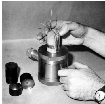
(d) Rock specimen inserted into oil-filled cell.
